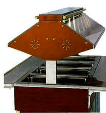
天蓋(スニーズガード) (SSH-1570シリーズ) アクリルのスニーズガードは、外壁に豪華なゴールド仕上ステンレス板を使用。ライトのフードアクセントのパイプにもゴールド仕上げを施し、衛生面や耐久性にファッション性をプラスしました。又、285mm~435mm(25mmピッチ)の範囲で上下スライドが可能です。
