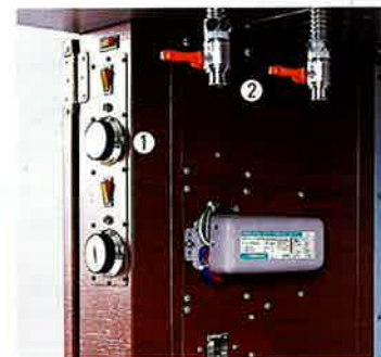
①温度調節機能 温度調節はサーモスタットによる自動制御ですから、常に希望の温度を保ちます。また、ヒーターの加熱中には赤ランプが、冷却機の作動中には白ランプが点灯します。
